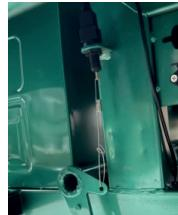
Cuando se presiona el freno de pie para activar la función de frenado, el interruptor gira automáticamente por acción del resorte, cortando la salida de energía de todo el sistema eléctrico. Esto evita que el vehículo continúe acelerando durante el frenado y mejora la seguridad, especialmente en frenadas de emergencia.
